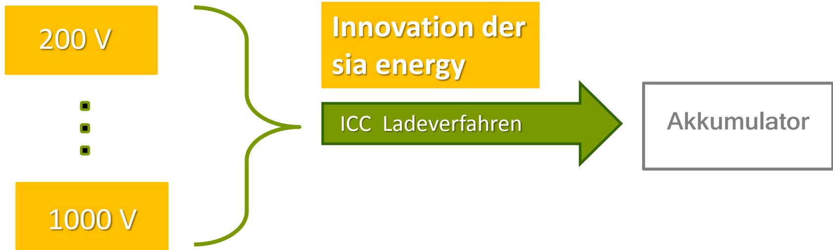
Durch die Innovation der sia energy ist es möglich, Eingangsspannungen zwischen 200 – 1000 V einer PV-Anlage nahezu verlustfrei in eine Batterie mit 100 V zu laden.
