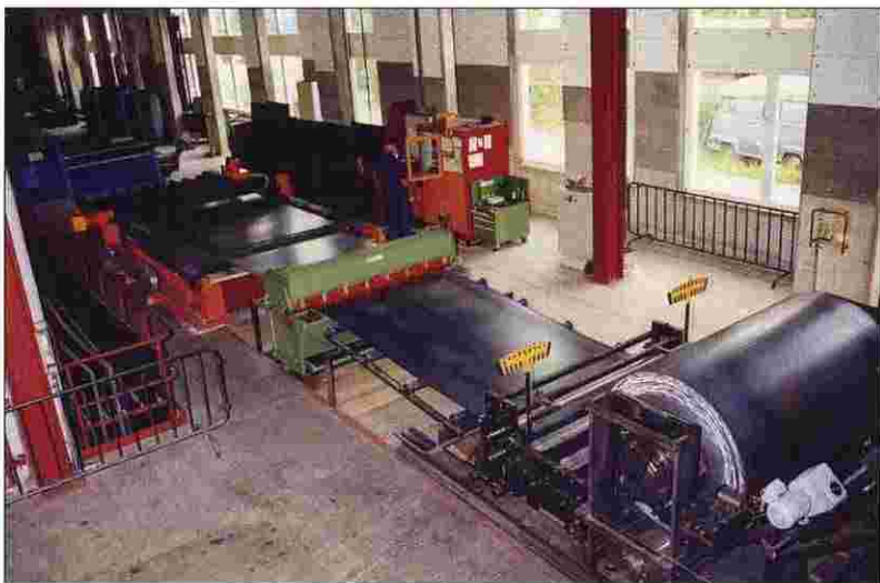
Moderne Speicherfabrikation in Oberburg. Das Mantelblech wird direkt ab Coil abgerollt und mit einer CNC-gesteuerten Plasmaschneidmaschine bearbeitet.
