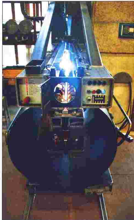
Schweissautomation: Eigenentwicklung zur raschen und perfekten Schweißung der Längsnähte.
